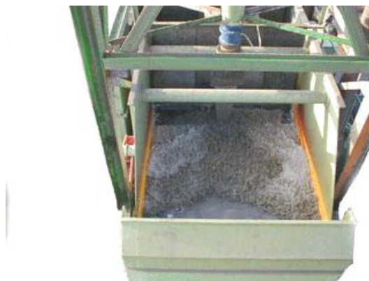
Unterlaufetaschenaustrag z10 auf Entwässerungssieb
