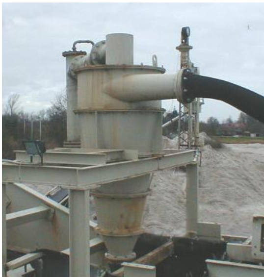
Z8 mit Stumpfkonus zur Feinkornreduzierung
